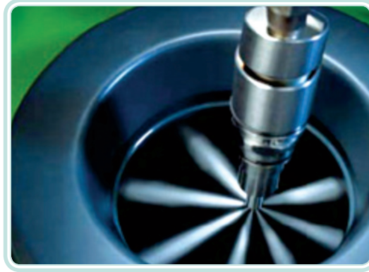
Figura 4.24: Ação do bico injetor
