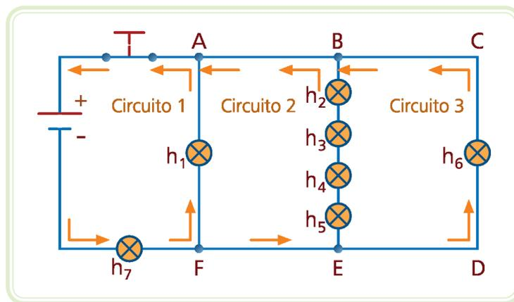
**Figura 7.8: Associação de resistores em série e paralelo**
