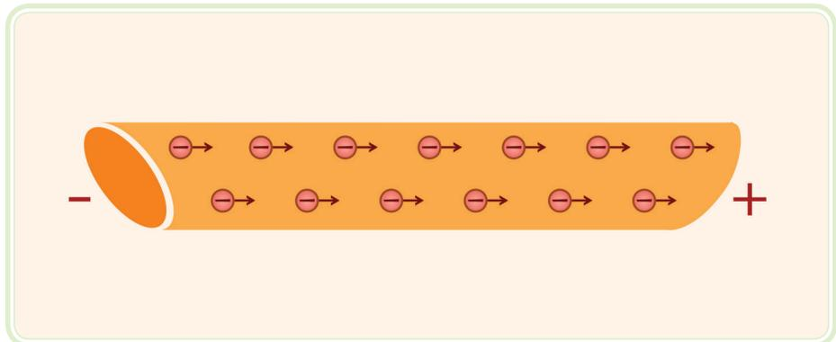
**Figura 7.4: Movimento dos elétrons quando aplicada uma diferença de potencial**
