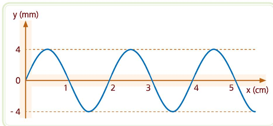
Figura 5.13: Onda formada por um vibrador de 3600 rpm
