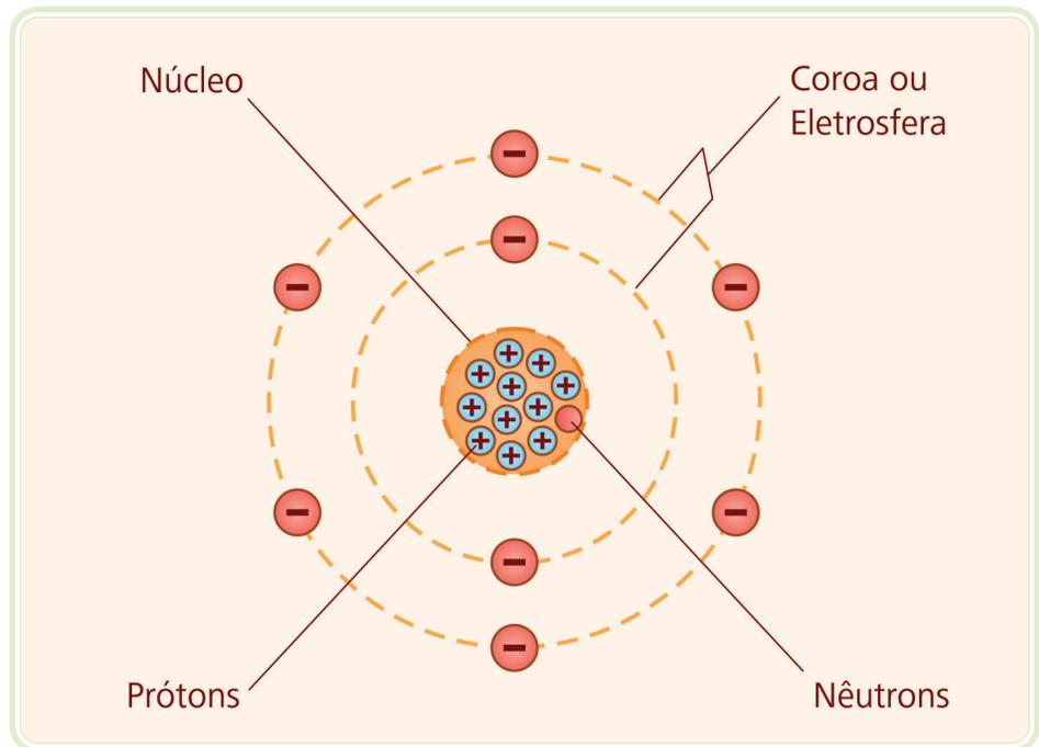
**Figura 7.1: Constituição de um átomo**
