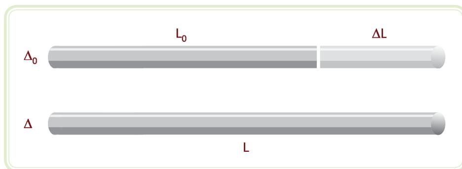
**Figura 3.8: Dilatação linear de uma barra**
