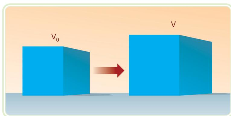
**Figura 3.10: Dilatação volumétrica de um corpo**
