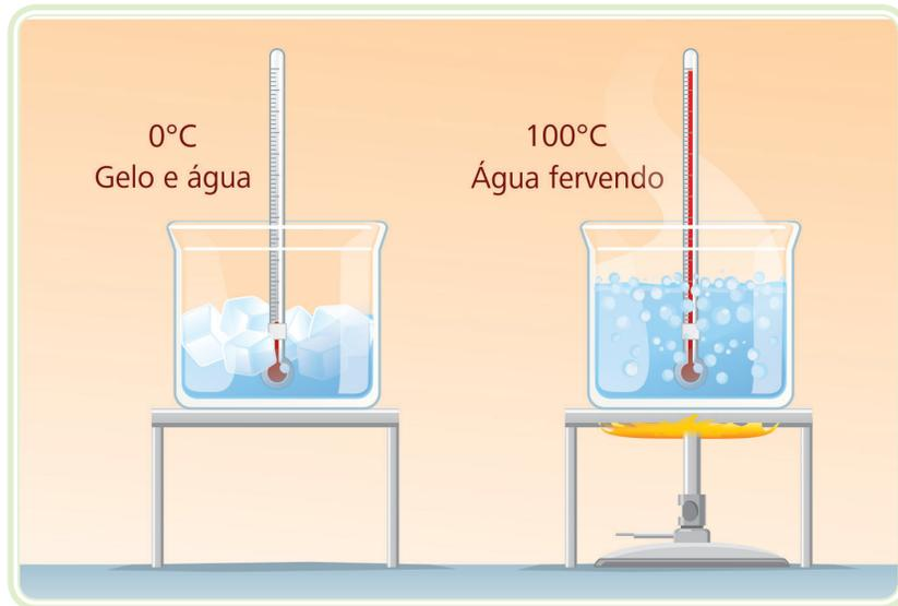
**Figura 3.1: Termômetro com dois pontos fixos**
