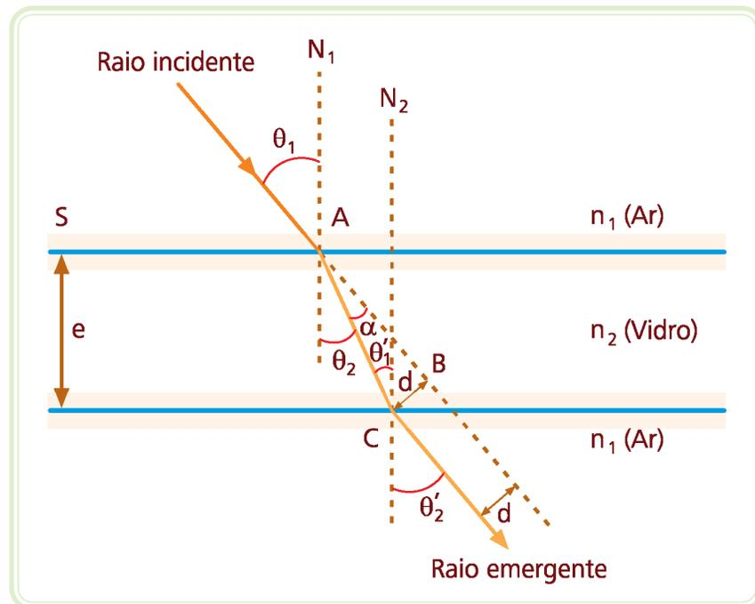
**Figura 6.15: Trajetória de um raio atravessando uma lâmina de faces paralelas**
