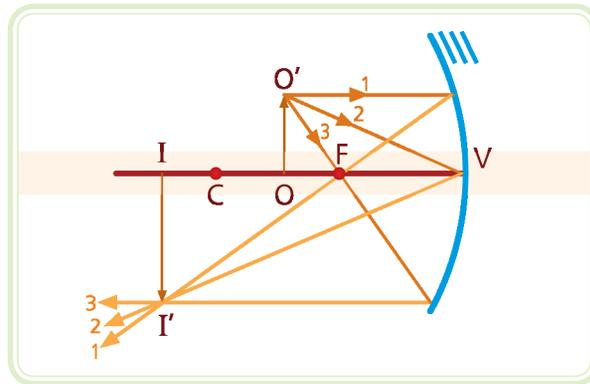
**Figura 6.19: Objeto entre centro de curvatura e foco do espelho esférico**
