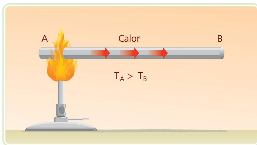
Figura 4.9: Condução de calor em barra
