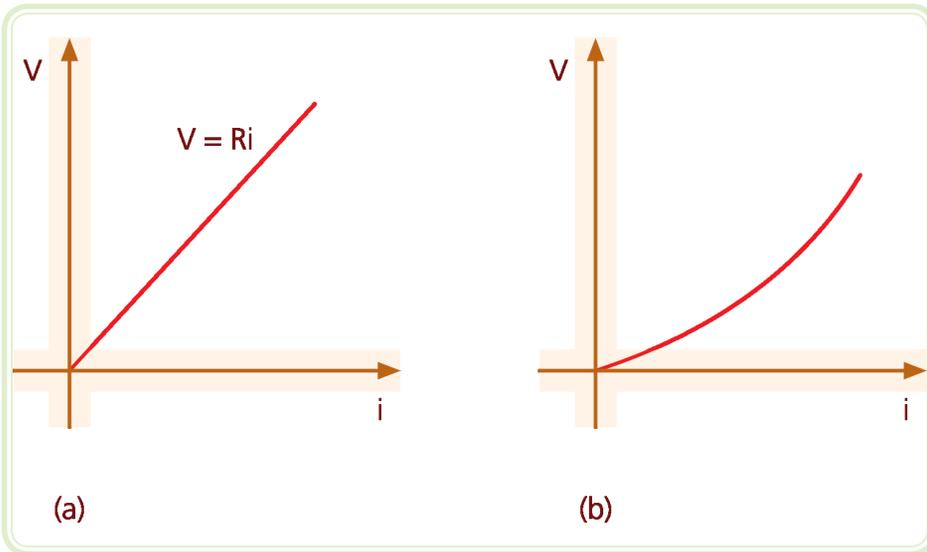
**Figura 7.5: Resistores ôhmicos obedecem a lei de Ohm (a) e resistores não ôhmicos não obedecem a lei de Ohm (b)**
