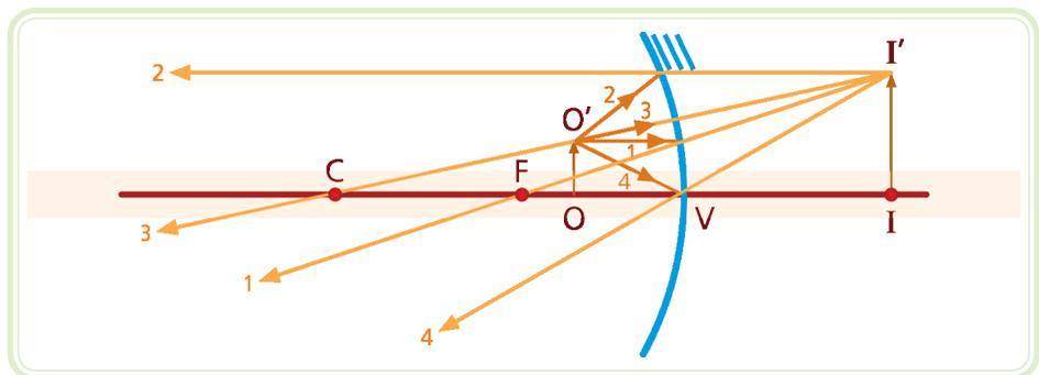
**Figura 6.21: Objeto entre o foco e o vértice do espelho esférico**
