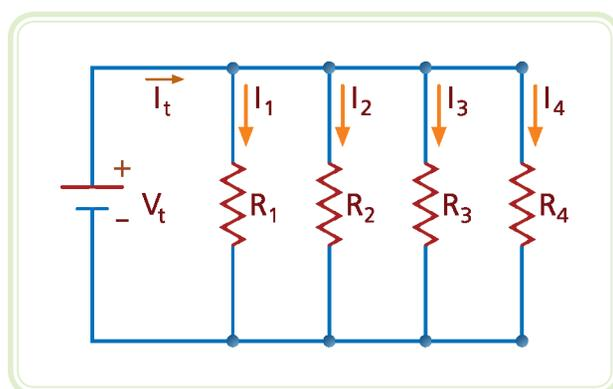
**Figura 7.7: Associação de resistores em paralelo**
