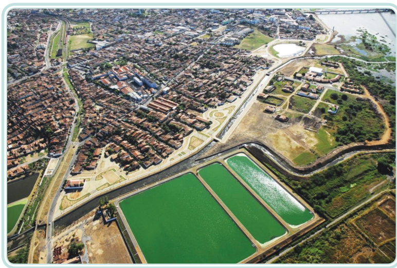
Figura 4.8: Série de lagoas de estabilização: lagoa anaeróbia + lagoa facultativa + lagoa de maturação. Note a cor verde produzida pela clorofila das algas presentes no efluente Fonte: http://sobralrevista.blogspot.com/2010/09/sobral-discute-novas-formas-de.html
