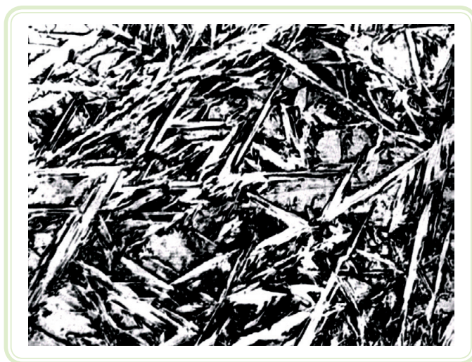
Figura 6.10: Microestrutura de aço duro temperado em água demonstrando as agulhas escuras de martensita em um fundo de austenita retida, que não se transformou durante o resfriamento brusco, em branco
