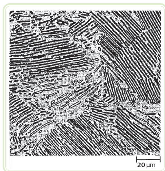
Figura 3.3: Aço carbono eutetoide (0,8% C), resfriado lentamente
