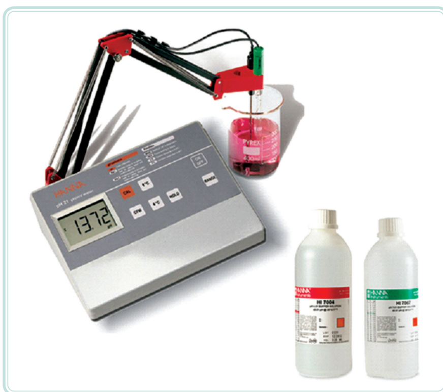
Figura 1.3: Leitura feita em um pHmetro de bancada
