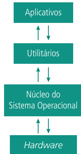
Figura 4.3: Posicionamento do núcleo do sistema operacional em um sistema computacional
