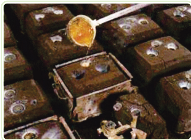
Figura 1.10: Momento de vazamento do metal no molde (aula prática de fundição nos laboratórios do IFPA, Campus Belém)
