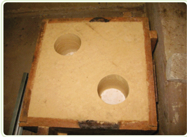
Figura 1.9: O molde está pronto para o vazamento (aula prática de fundição nos laboratórios do IFPA, Campus Belém)
