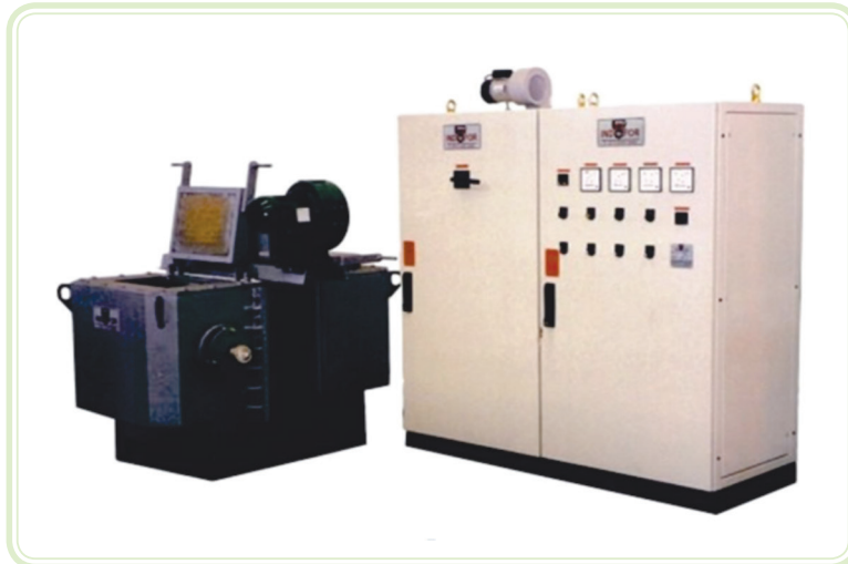
Figura 6.5: Modelo de forno de indução a canal de baixa frequência com dupla bacia Fonte: Autor
