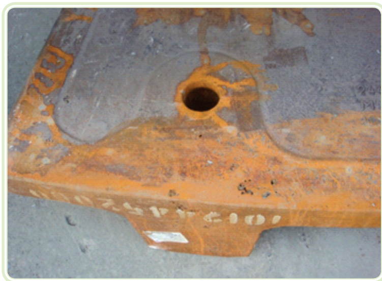
Figura 9.8: Peça de alta criticidade que apresenta inclusões de areia e bolhas
