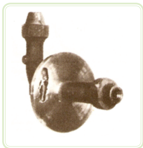
Figura 9.2: Bolha alongada, causada por excesso de gás no banho metálico
