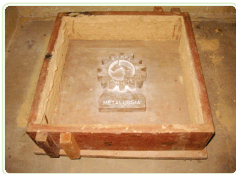
Figura 1.2: Colocação do modelo sobre a prancha de socamento (aula prática de fundição nos laboratórios do IFPA, Campus Belém)
