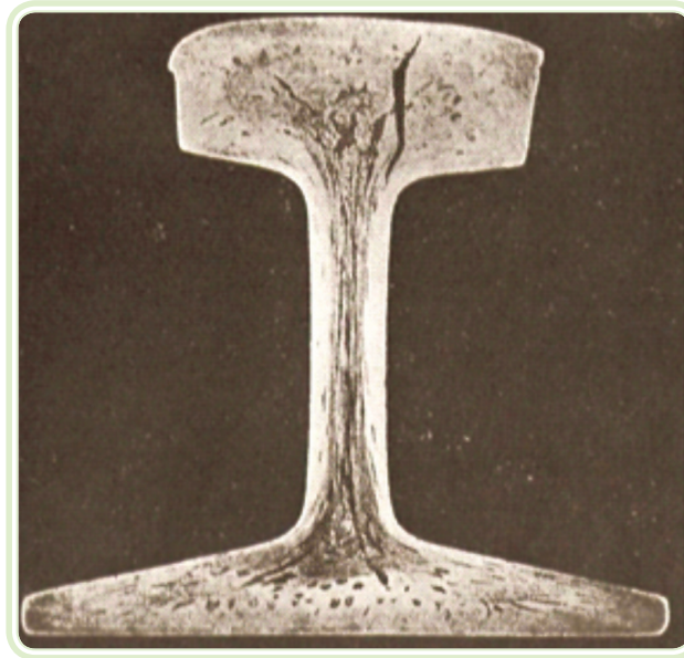
Figura 10.1: Seção transversal de um trilho com intensa segregação e bolhas e uma fissura interna no boleto
