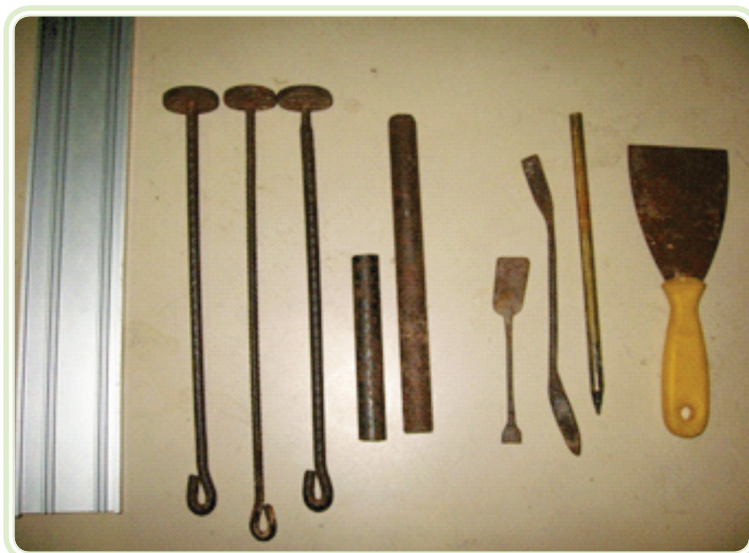
Figura 1.5: Ferramentas de compactação da areia de enchimento (aula prática de fundição nos laboratórios do IFPA, Campus Belém)
