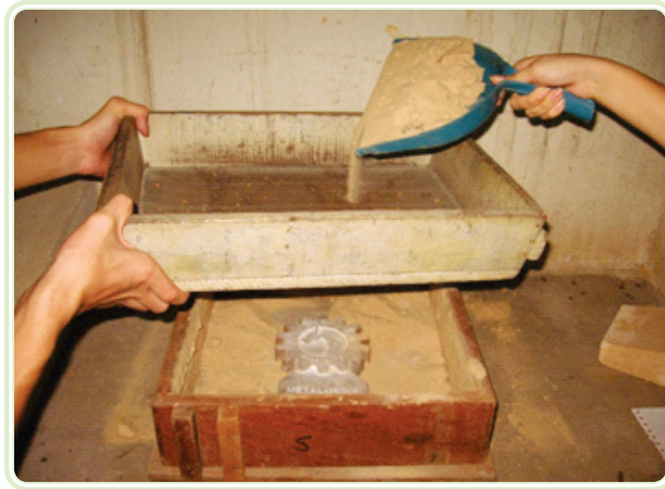
Figura 1.3: Aplicação da areia de faceamento através de peneiramento numa espessura de aproximadamente uma polegada (aula prática de fundição nos laboratórios do IFPA, Campus Belém)
