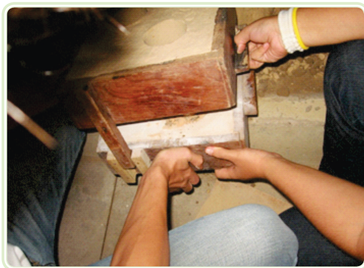
Figura 1.7: O fundo foi invertido para a retirada do modelo (aula prática de fundição nos laboratórios do IFPA, Campus Belém)
