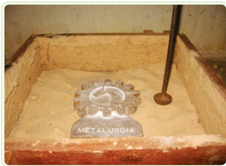
Figura 1.4: Etapa de compactação da areia de enchimento, com auxílio de uma ferramenta (aula prática de fundição nos laboratórios do IFPA, Campus Belém)
