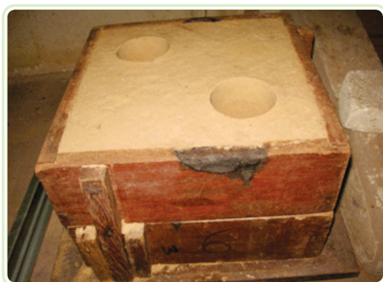
Figura 1.8: Operação de abertura de furos no molde, para prosseguir com o vazamento (aula prática de fundição nos laboratórios do IFPA, Campus Belém)
