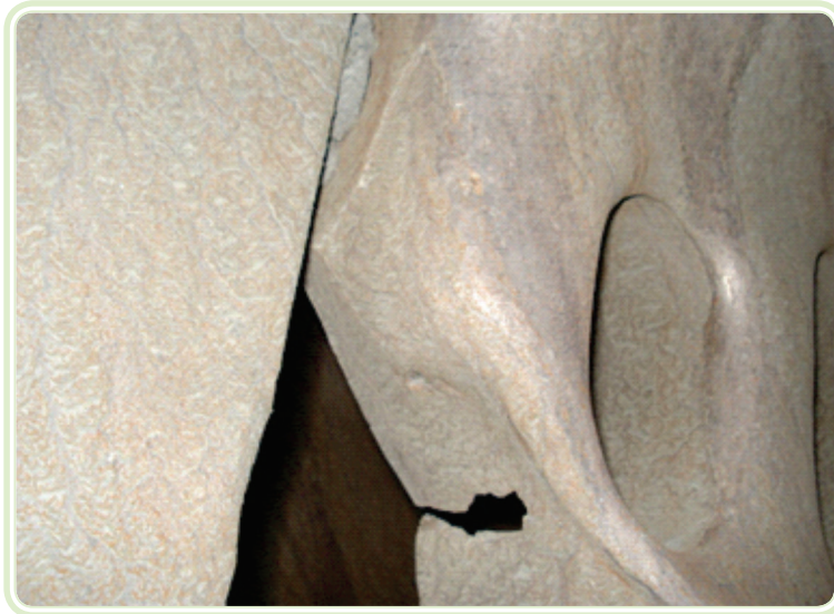
Figura 9.5: Detalhe do defeito de fundição que motivou a falha da peça mostrada em conjunto na foto anterior
