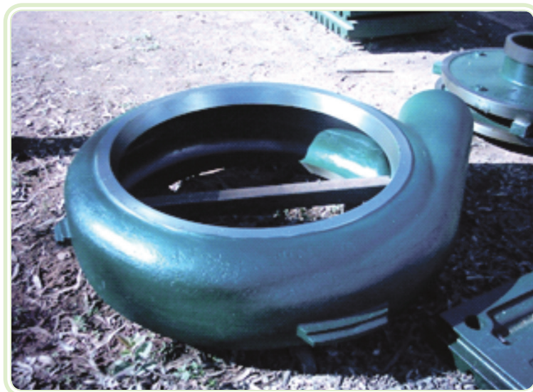
Figura 1.14: Uma carcaça de bomba após limpeza (rebarbação)
