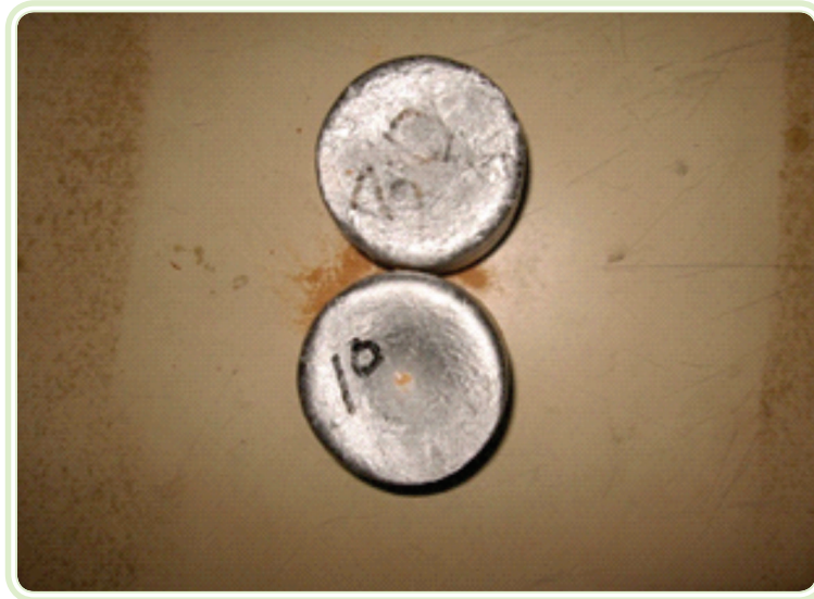
Figura 1.13: Duas peças de alumínio desmoldadas (aula prática de fundição nos laboratórios do IFPA, Campus Belém)
