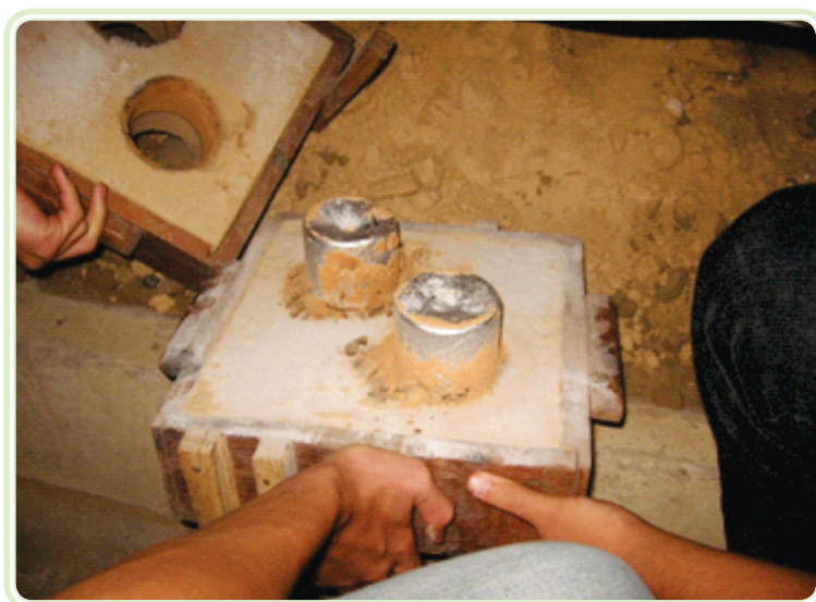
Figura 1.12: Duas peças de alumínio desmoldadas, mostrando as rebarbas e os canais (aula prática de fundição nos laboratórios do IFPA, Campus Belém)
