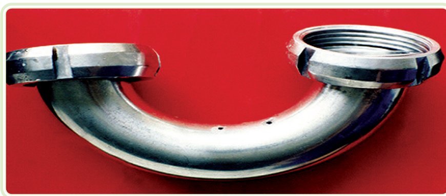
Figura 1.6: Corrosão por pite em aço inoxidável
