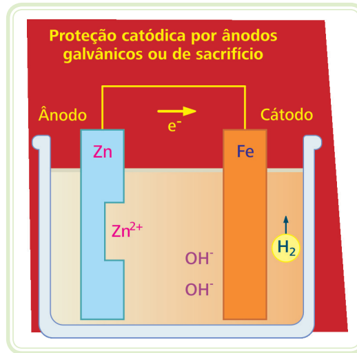
Figura 7.1: Proteção catódica por ânodos de sacrifícios
