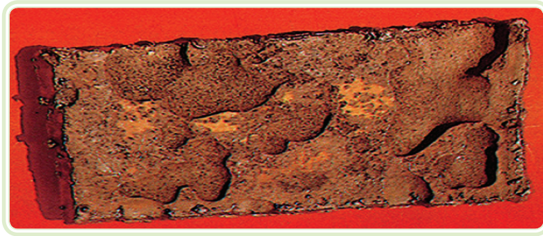
Figura 1.4: Corrosão em placas
