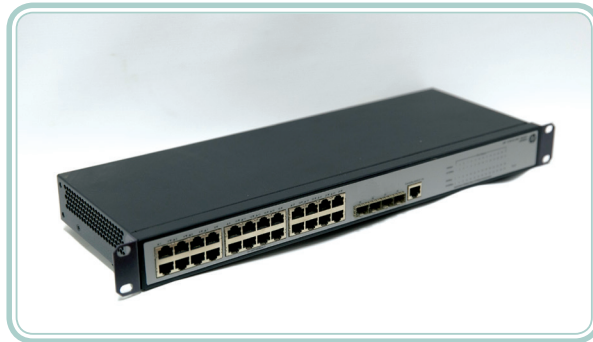
Figura 7.2: Switch de rede Fonte: CTISM
