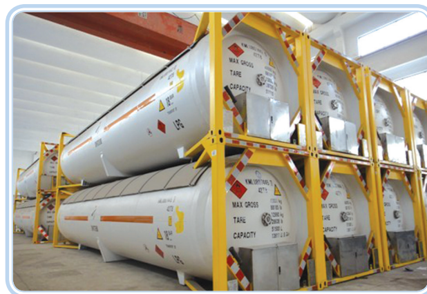
Figura 6.14: Contêineres tanque sinalizados
