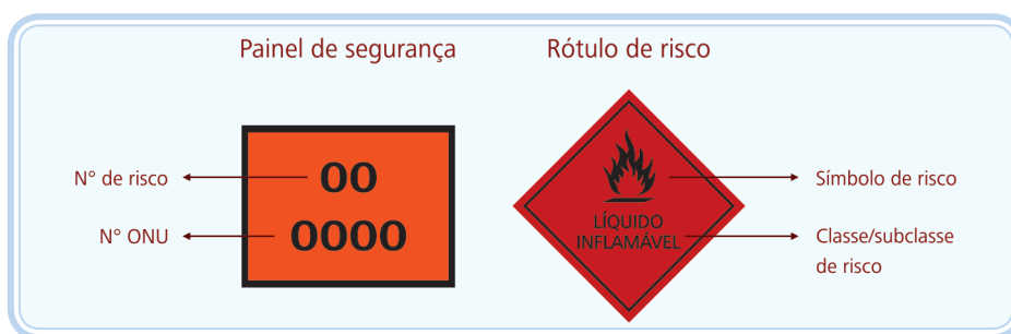
Figura 4.2: Painel de segurança e rótulo de risco
