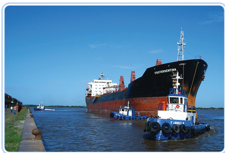
Figura 6.4: Operação de atracação de navio
