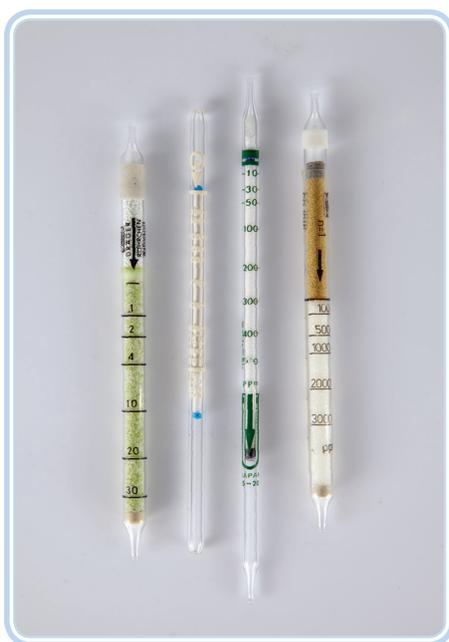
Figura 1.9: Tubos colorimétricos
