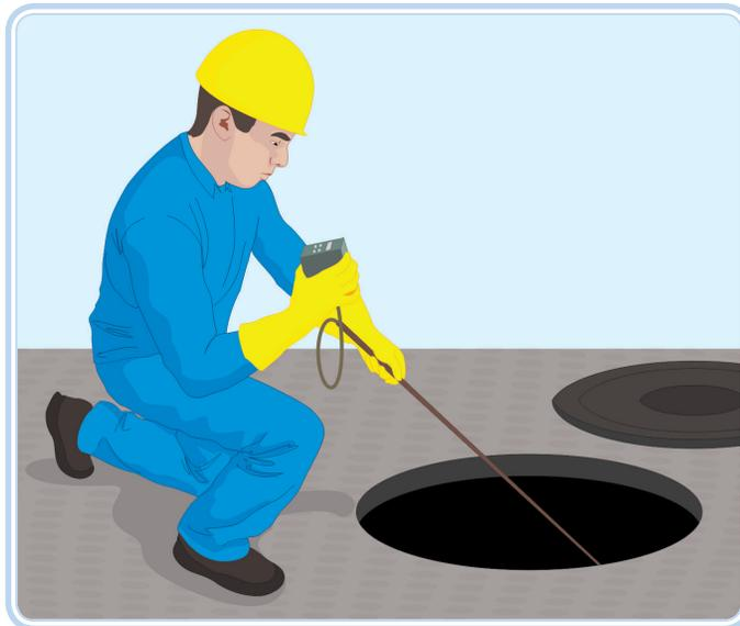
**Figura 5.7: Teste atmosférico**
