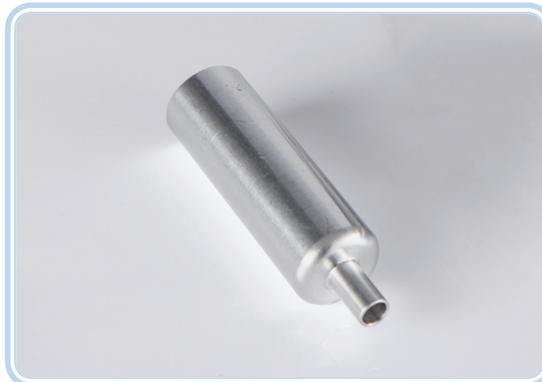
**Figura 3.7: Câmara de calibração para ciclone de alumínio**
