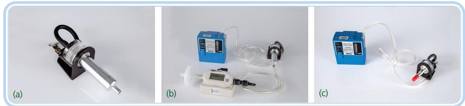
**Figura 3.13: Calibração com ciclone de alumínio (a e b) e esquema para a amostragem (c)**
