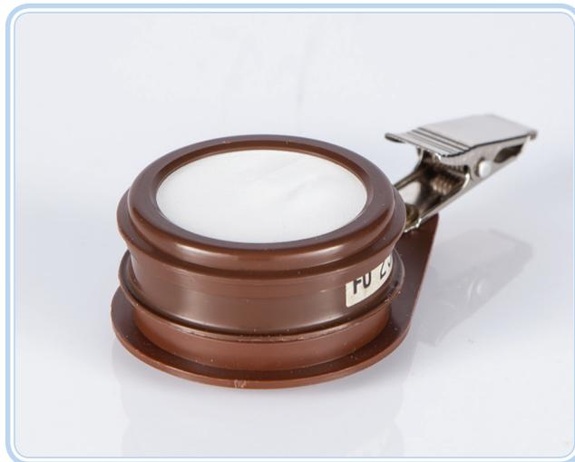
**Figura 4.6: Amostrador passivo**
