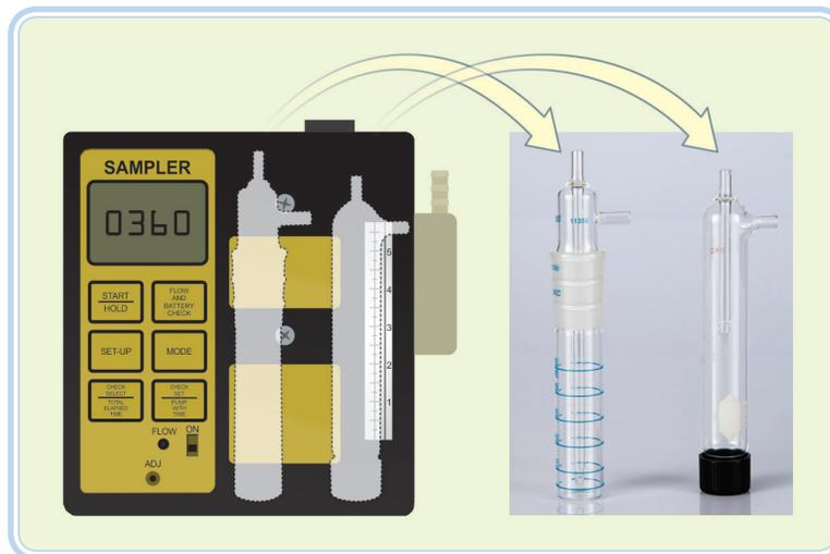
**Figura 1.7: Exemplo de amostrador com líquido absorvente (impinger)**
