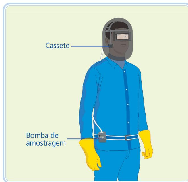
**Figura 3.23: Amostrador dentro da máscara de soldagem**
