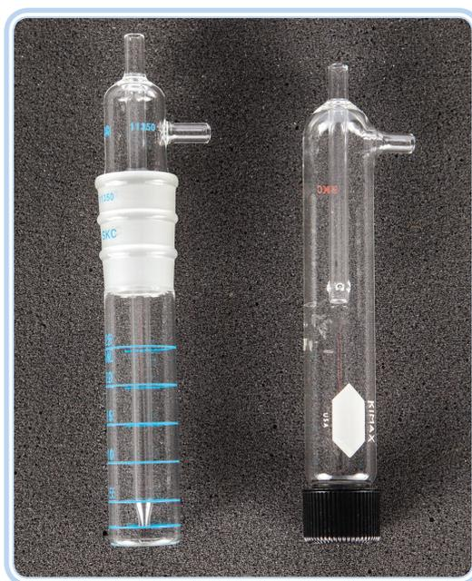
Figura 4.5: *Impinger e impinger trap*
