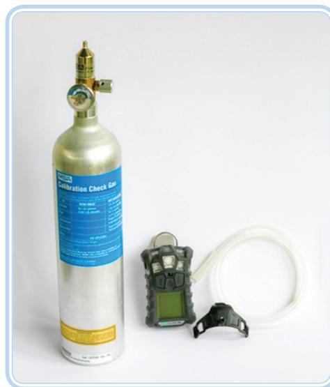
**Figura 5.10: Detector de gases também usado para monitoramento contínuo, à esquerda, o cilindro de calibração**
