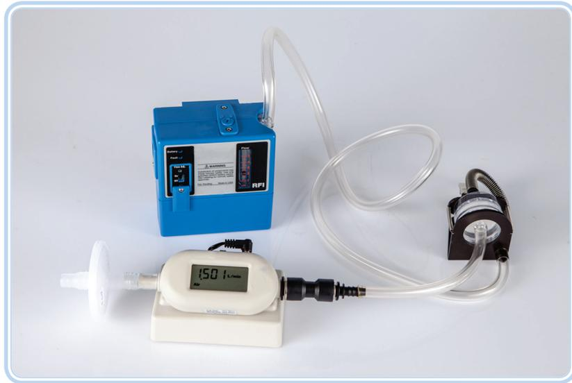
**Figura 3.16: Calibração em amostragem de poeira total**
