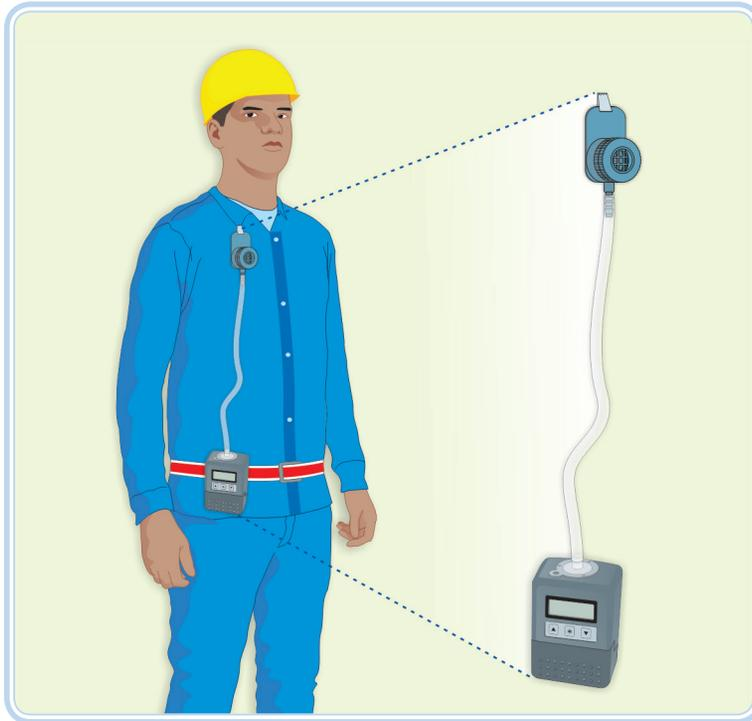
**Figura 3.18: Amostrador IOM na zona respiratória conectado a uma bomba de amostragem**
