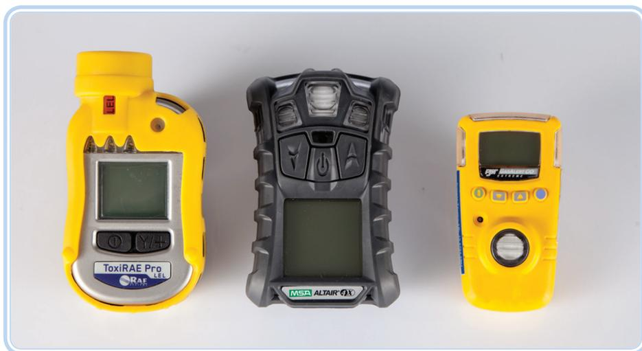
**Figura 4.2: Equipamentos eletrônicos para avaliação de gases e vapores**
