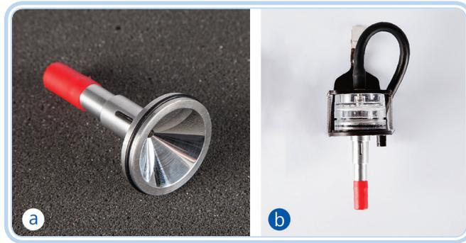
**Figura 3.6: Ciclone de alumínio (a) e montagem do conjunto no porta cassette (a)**
