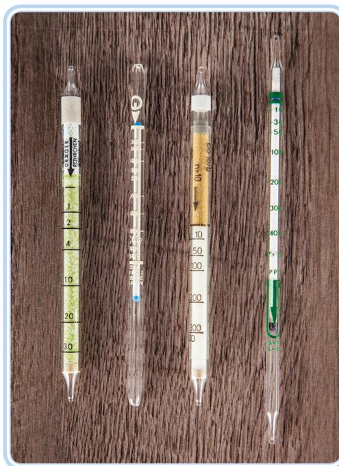
**Figura 4.1: Tubos colorimétricos**
