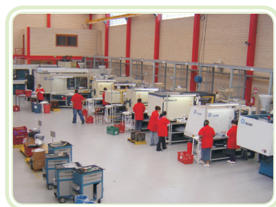
Figura 2.9: Distância normalizada entre máquinas
