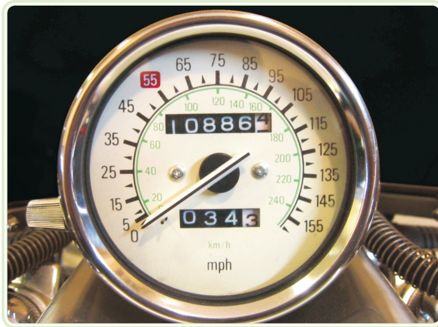
Figura 6.2: Velocímetro e odômetro de uma motocicleta
