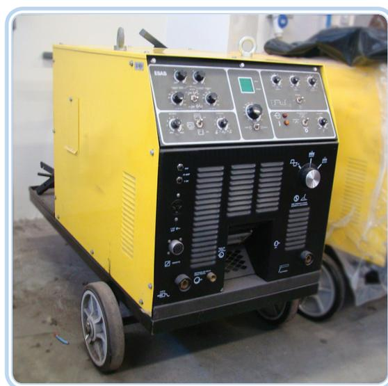
Figura 6.2: Aparelho para soldagem TIG
