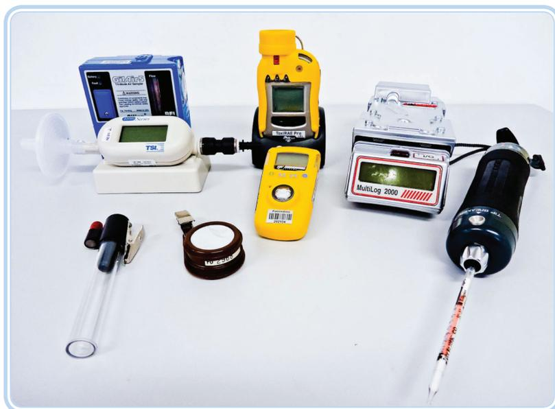
**Figura 5.9: Instrumentação para avaliação de gases e vapores**
