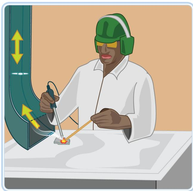
**Figura 1.6: Controle: ventilação local exaustora de processo**
