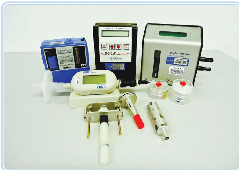
**Figura 5.4: Instrumentação para avaliação de poeiras e fumos metálicos**
