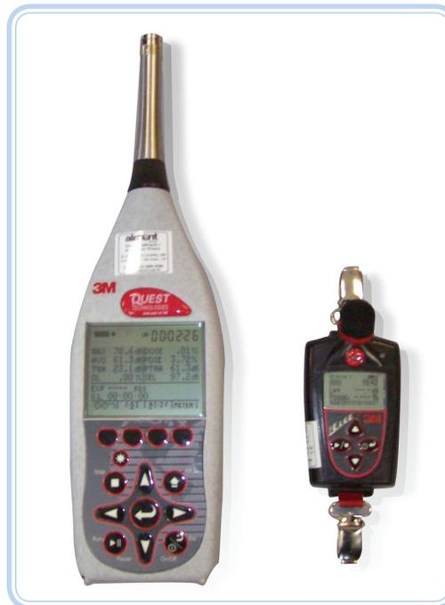
**Figura 4.1: Medidor de nível de pressão sonora (decibelímetro) e dosímetro de ruído**
