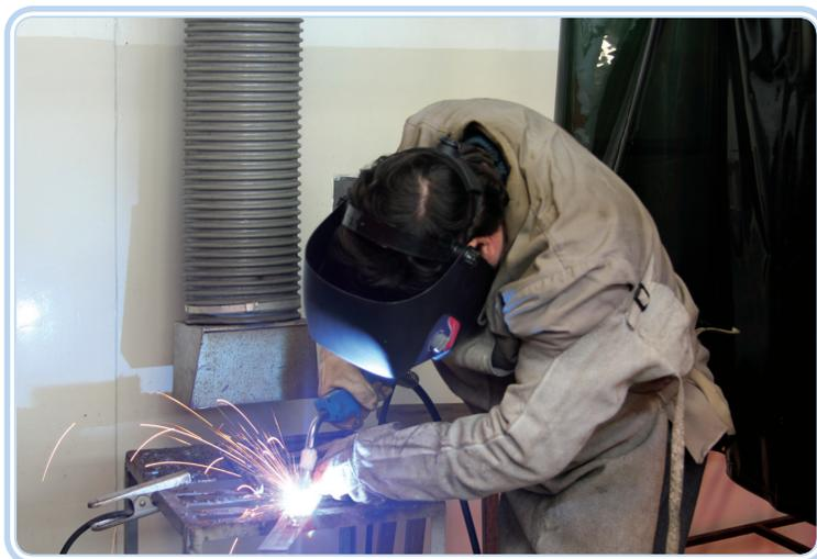
**Figura 3.8: Solda por arco elétrico com máscara eletrônica**
