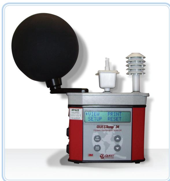
**Figura 4.2: Monitor de stress térmico para avaliação do IBUTG**
