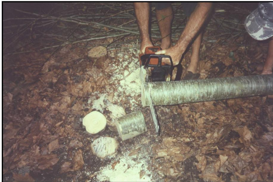
FIGURA 5 - Seccionamento dos toretes para pesagem e obtenção dos discos de *Platanus x acerifolia*.
