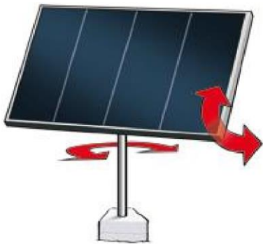
Fig. 2. Módulo com estrutura de rastreamento de dois eixos.
