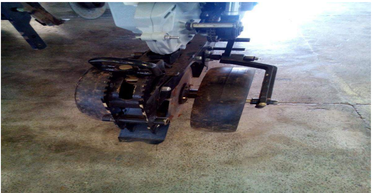
Figura 2 – unidade semeadora sem mecanismo cobridor de sulco.
