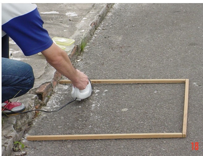
Figura 3 - A área de amostragem é isolada por uma moldura de madeira e é aspirada com a utilização de um aspirador.
