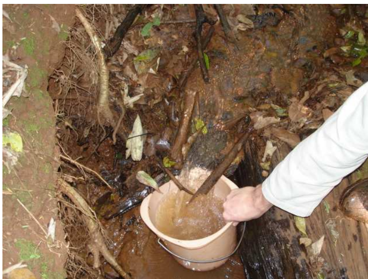
Figura 2: Medição da vazão pelo método volumétrico.
