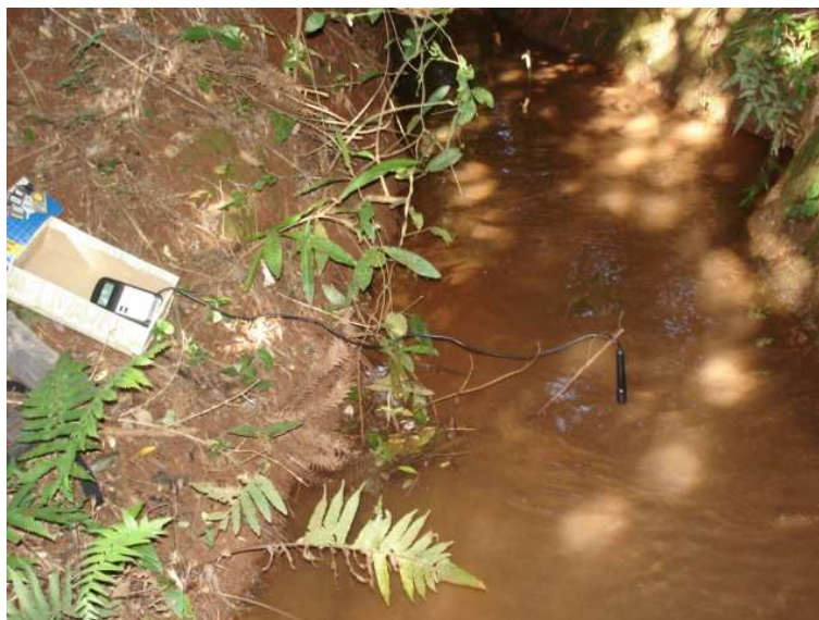
Figura 4: Instalação do sensor do condutivímetro na água, fixado com pino metálico.
