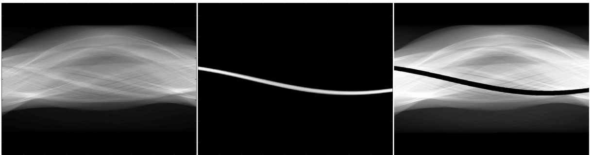
Figura 4.3 – Subtração dos sinogramas. Da esquerda para a direita temos: Sinograma da imagem original; Sinograma do metal segmentado; Subtração dos sinogramas
