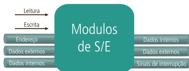
Figura 5.2: Troca de informações em módulo de E/S
