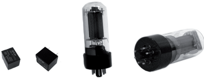
Figura 2.2: Relés (E) e Válvulas (D)
