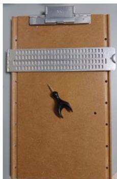
Descrição: foto retangular colorida de uma reglete de mesa, cuja base é de madeira e grade em alumínio. A grade é formada por quatro linhas. Em cada linha, há 28 celas braille. Sobre a reglete, há um punção, cuja parte superior é acrílico preto e ponta metálica.
