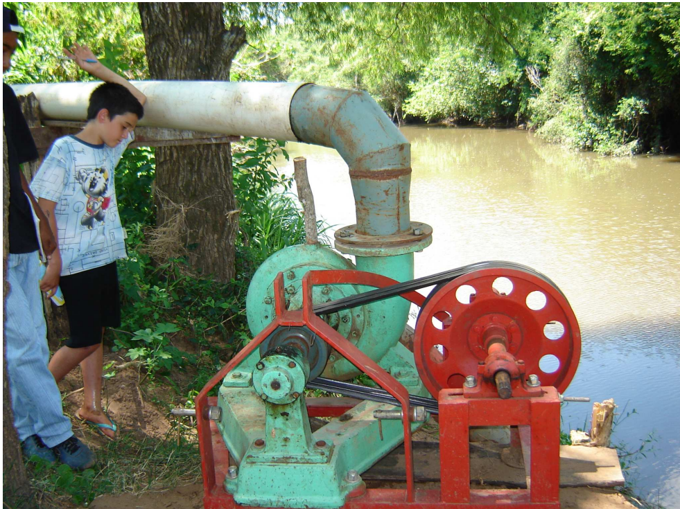
Localidade de Invernadinha. Conjunto moto-bomba na margem do Arroio Grande para o recalque de água para a lavoura de arroz, antes do ponto em que o Arroio Grande divide-se, dando origem ao início do Arroio do Meio.
