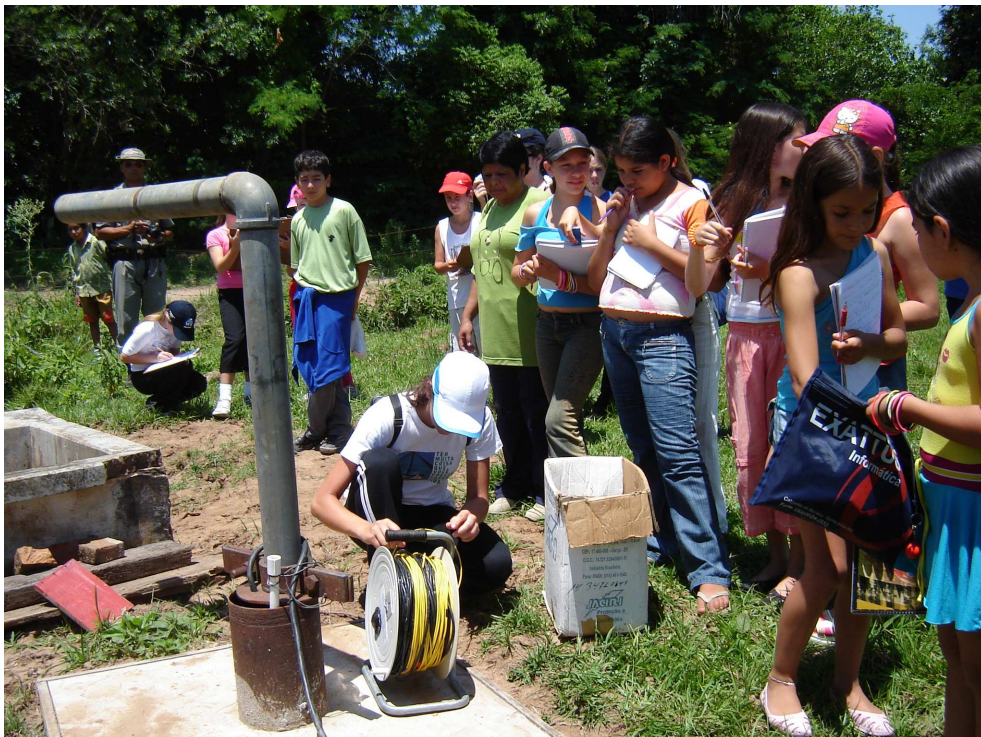
Demonstração do controle da profundidade e da qualidade da água em poços artesanais por alunos de Geografia da UFSM, orientados do Prof. José Luiz Silvério da Silva.
