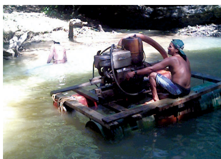
Figura 19. Draga utilizada para retirada de areia do poço da cachoeira
