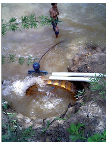
Figura 13. Roda d'água com bomba para geração de energia
