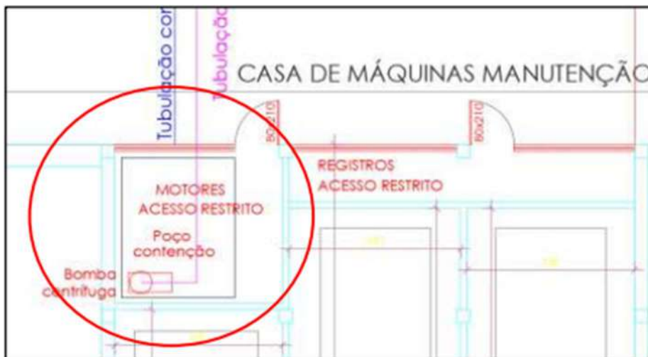
Figura - Casa de máquinas manutenção e primeiro ponto de contaminação de óleo
