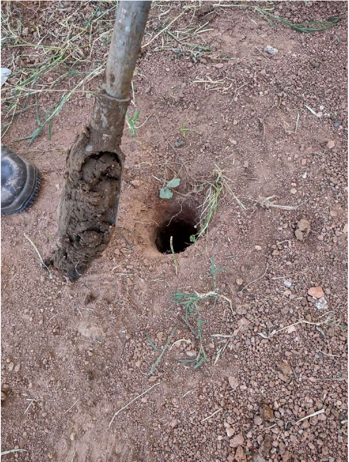
Figura 4 – Amostra de solo no coletor do trado recentemente retirada de ponto de coleta na área do HUSM.
