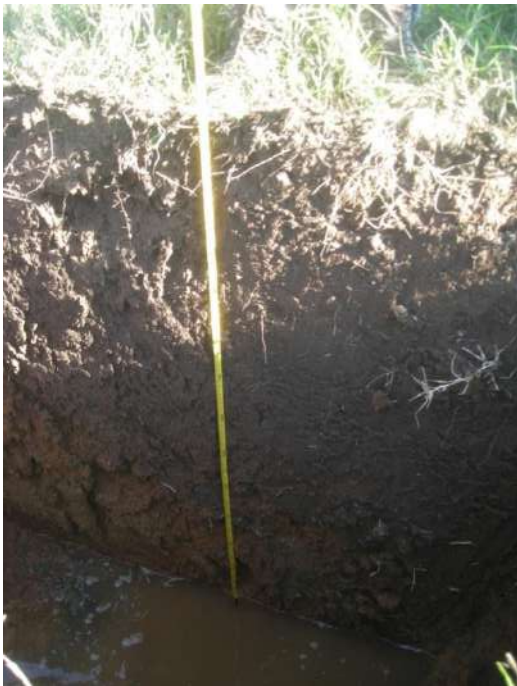
Fotografia da T3 –observar presença de água em 0,75cm.
