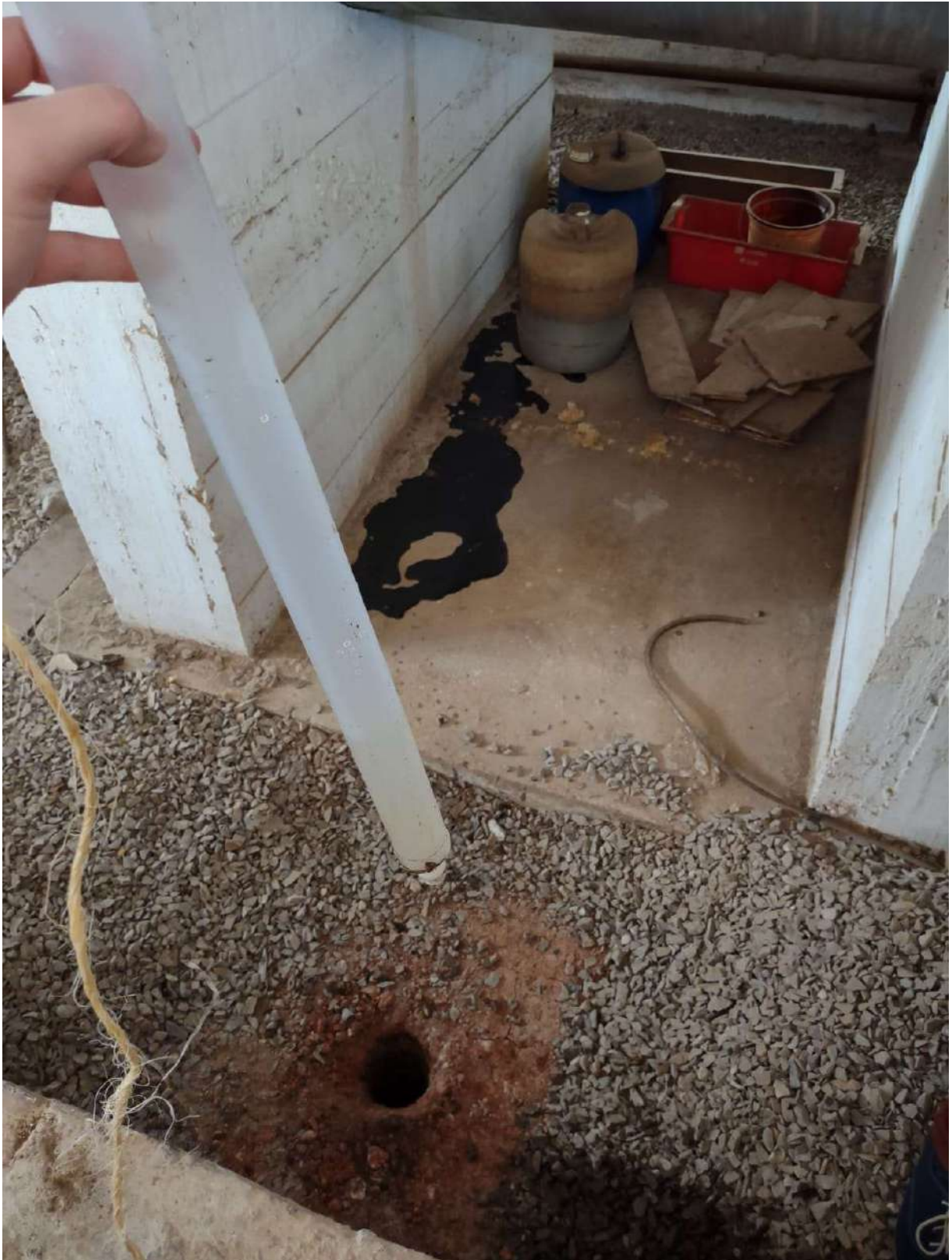
Figura 3 – Bailer contendo água subterrânea, após a coleta, feita dentro do depósito de combustíveis do RU. Mostrando combustível derramado, abaixo do tanque.
