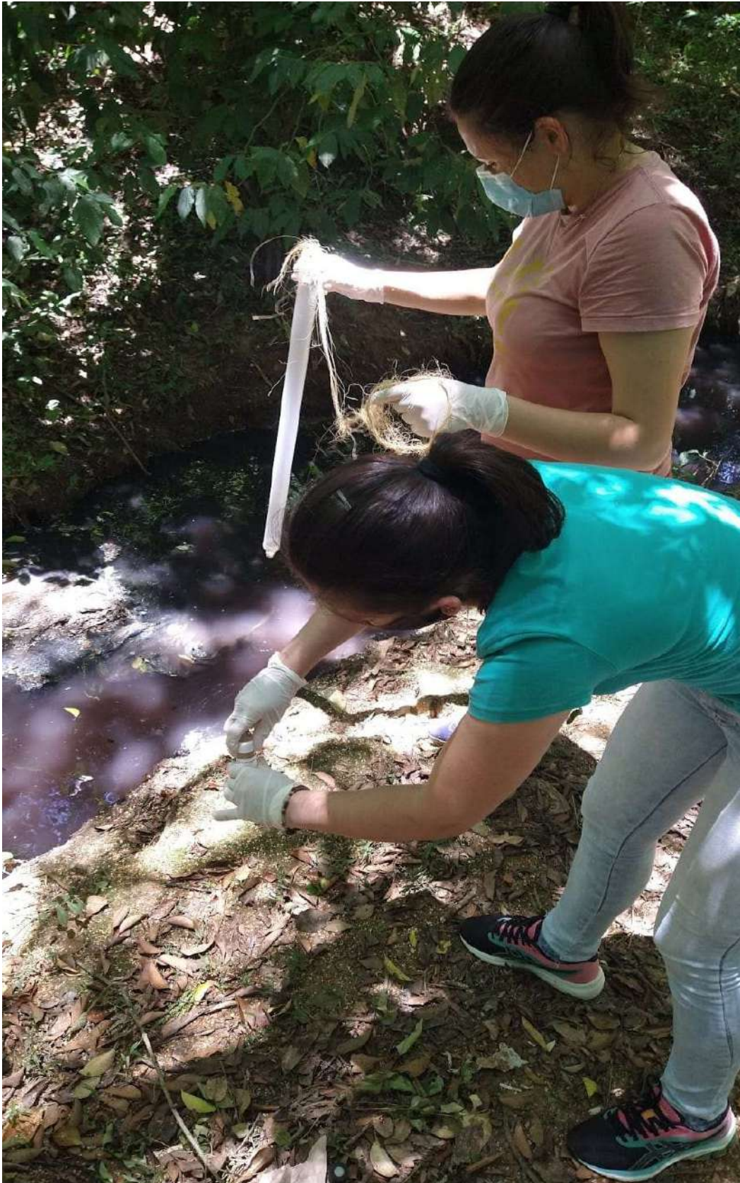
Figura 13 – Coleta de água superficial em um dos pontos da Sanga do Lagoão do Ouro.
