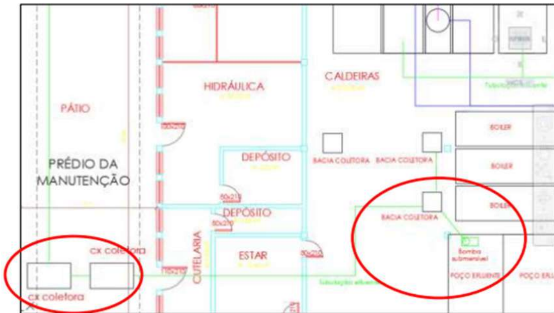
Figura - Bomba de submersíveis, que encaminha o efluente à bacia coletora, que posteriormente vai para caixas coletoras e depois para fora do pátio na coletora de efluentes.
