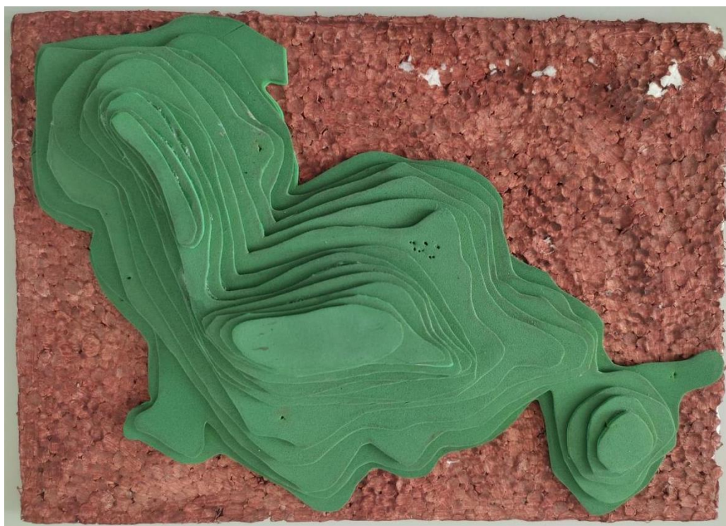
Figura 17: Representação volumétrica de curvas de nível (maquete - 3D)
